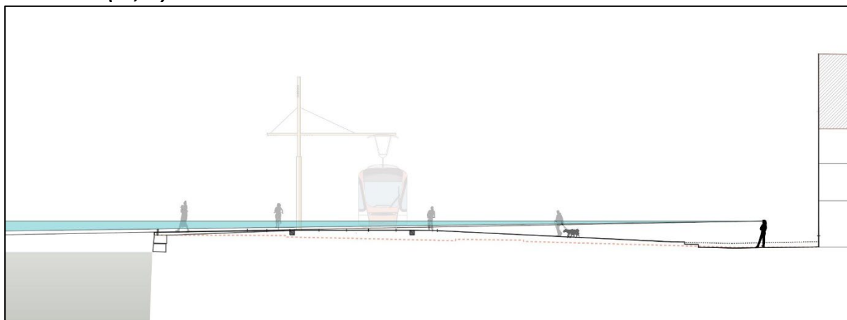
Figur 42 I dette snittet heves kaikanten med ca. 20 cm for å få et godt tverrfall (1:70). Som vi ser av illustrasjonen, vil dette redusere sikten mot Vågen noe. Stiplet linje viser dagens terrengoverflate. (Ill: Mot Vågen)
